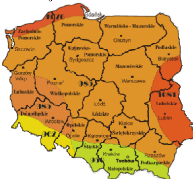
Rysunek 3. Rejonizacja średniorocznych sum promieniowania słonecznego całkowitego padającego na jednostkę powierzchni poziomej w kWh/m 2 /rok. Liczby wskazują całkowite zasoby energii promieniowania słonecznego w ciągu roku dla wskazanych rejonów kraju
